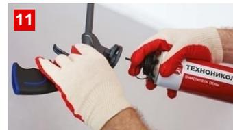
11 После завершения работ необходимо тщательно очистить пистолет с помощью очистителя монтажной пены ТЕХНОКОЛЬ.
