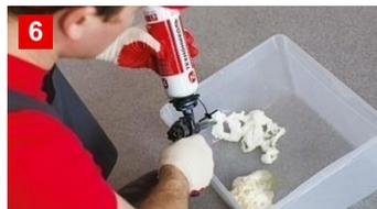
6 Отверните регулировочный винт пистолета, нажав на спусковой крючок, сравните некоторое количество пены в контейнер.
